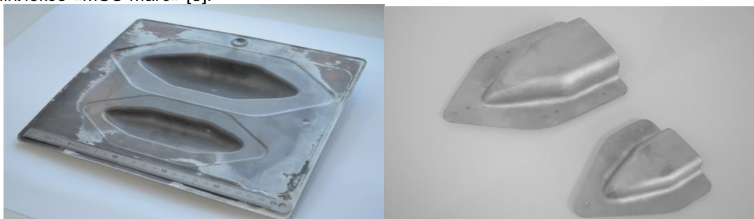
Рис. 3. Изготовление детали в режиме сверхпластичности
