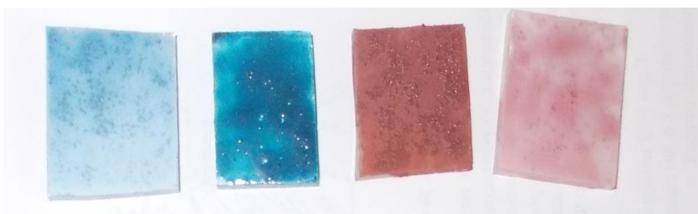
Рис. 9. Материал для мозаики после испытания стойкости к хлорированной воде
