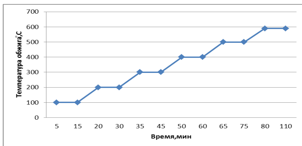
Рис. 5. Температурный режим медленного подъема температуры с выдержкой в печи
