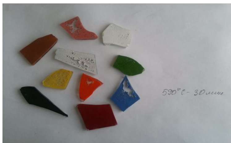
Рис. 4. Материал после обжига без ступенчатой выдержки при быстром подъеме температуры
