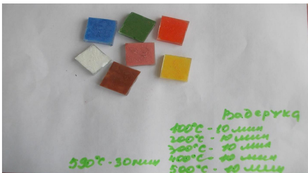
Рис. 6. Образцы после обжига с выдержкой каждые 100 градусов
