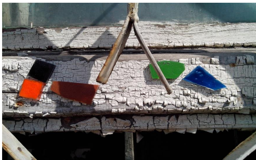
Рис. 8. Внешний вид материала при испытании в естественных условиях на 90 день
