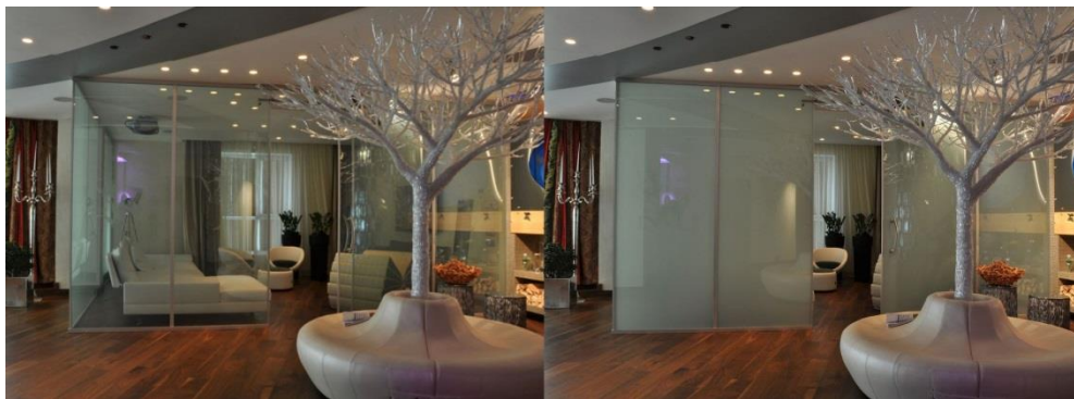
Рис. 2. Смарт-стекло с изменяющейся прозрачностью
