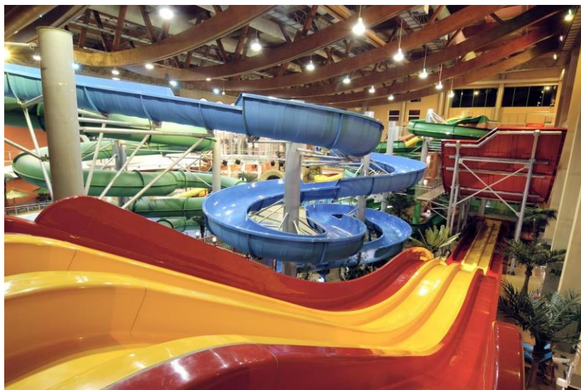
Рис. 5. Аквапарк в г. Мытищи: интерьер (линзообразное перекрытие фермами из клееной древесины)
