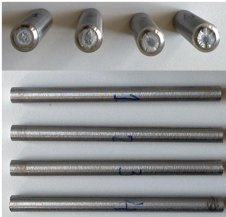
Рис. 10. Образцы после испытаний на учебной машине WP 140
