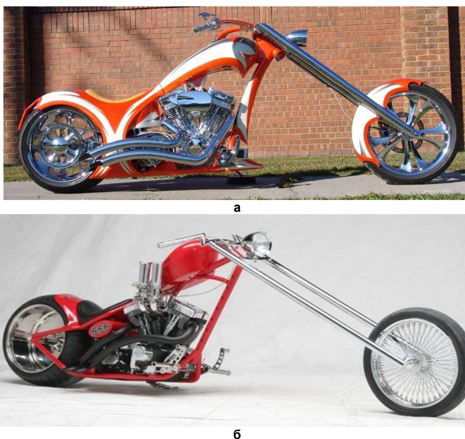
Рис. 3. Пример мотоциклов, не оборудованных подвеской колес, обеспечивающей виброзащиту водителя и пассажира: а – Meds bike s1200 (США); б – Iron Chopper (Великобритания)
