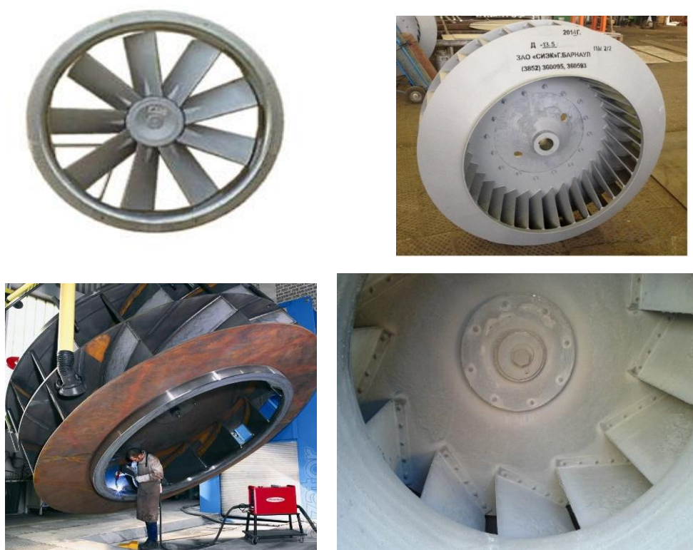
Рис. 3. Примеры циклически симметричных сварных конструкций
