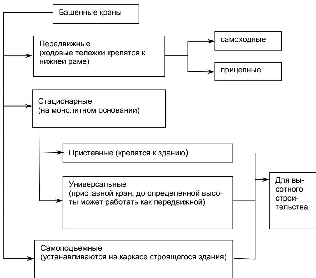
**Рис. 3. Классификация башенных кранов по возможности перемещения**
