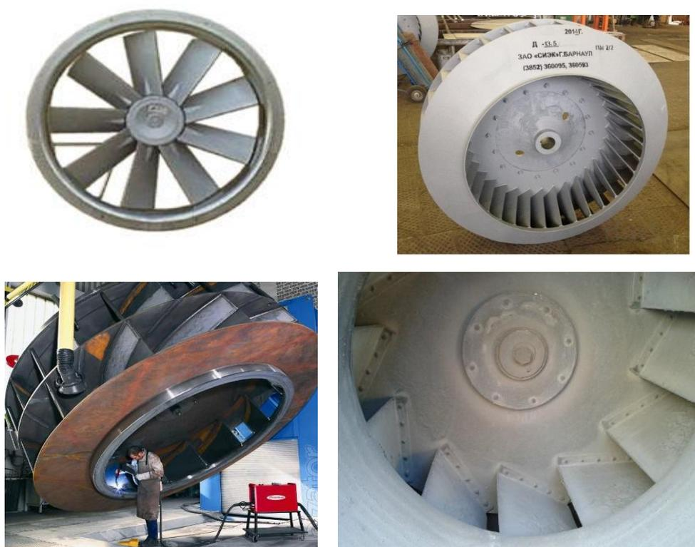
**Рис. 3. Примеры циклически симметричных сварных конструкций**
