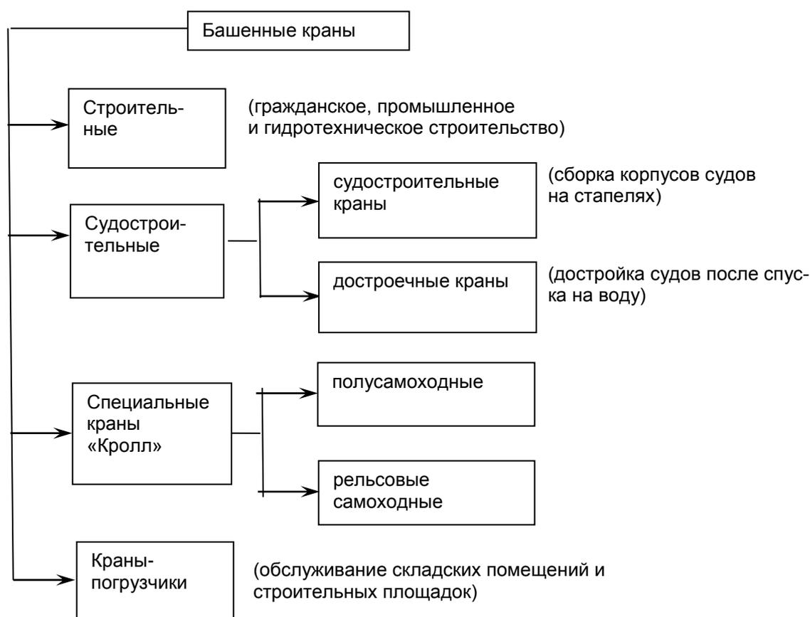
**Рис. 2. Классификация башенных кранов по области применения**
