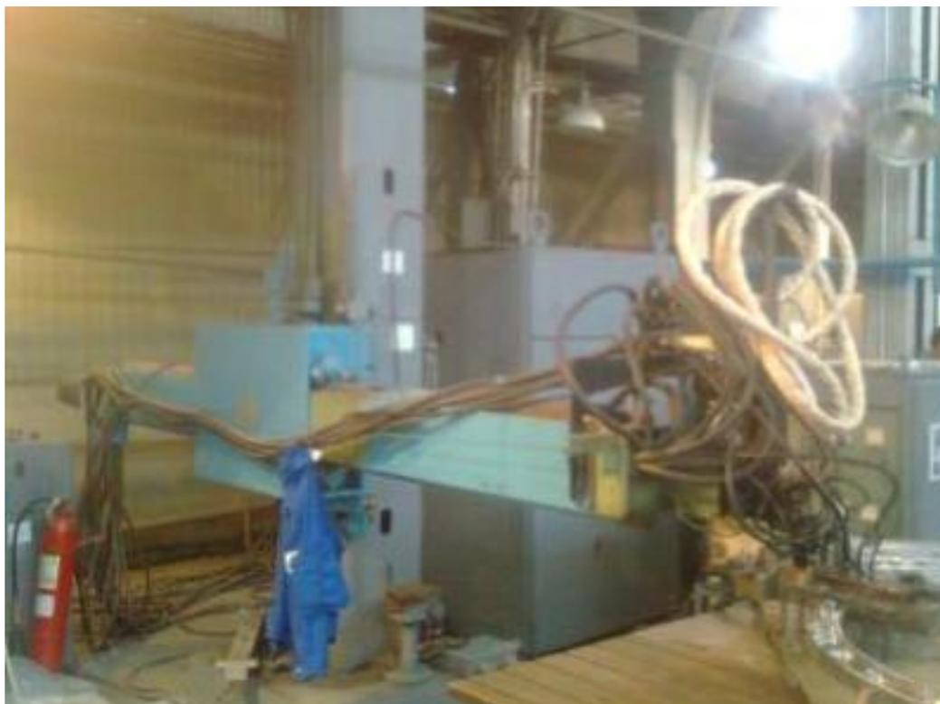
**Рис. 2. Установка для сварки погруженной дугой**
