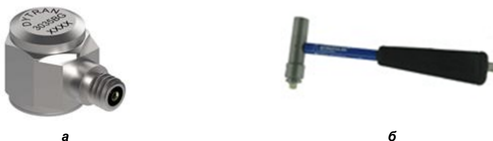
Рис. 2. Оборудование для проведения эксперимента: а – миниатюрный датчик вибрации (Model 3035BG, Miniature Accelerometer); б – молоток для модального анализа с датчиком силы Dynapulse
