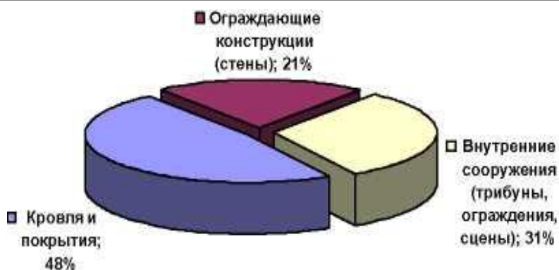
Рис. 1. Результат анализа обрушений спортивных сооружений
