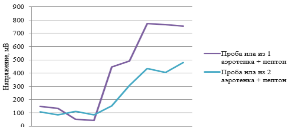
Рис. 12. График напряжения, генерируемого в микробных топливных элементах активным илом при добавлении пептона (0,5 г/л) в качестве субстрата в период с 9 по 14 апреля 2017 г.
