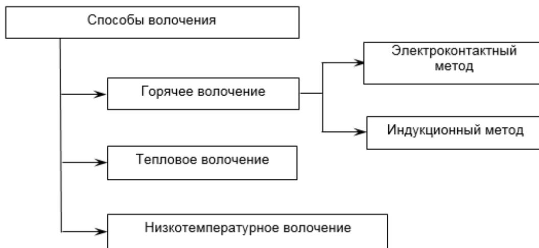
**Рис. 1. Классификация способов волочения по термическим условиям**
