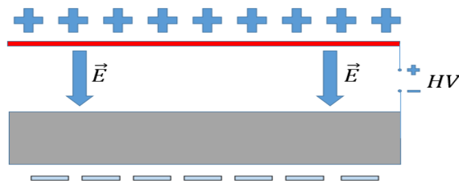
Рис. 2. Принцип работы хонейкомб-анода и хонейкомб-катада в продольном сечении
