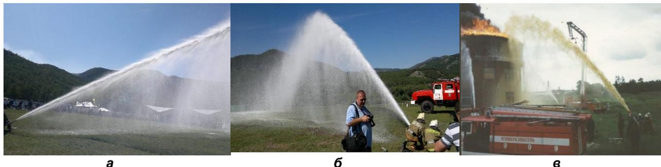
**Рис. 5. Работа с земли по пене модификации универсального пожарного ствола ИРНТУ в лафетном исполнении:**
