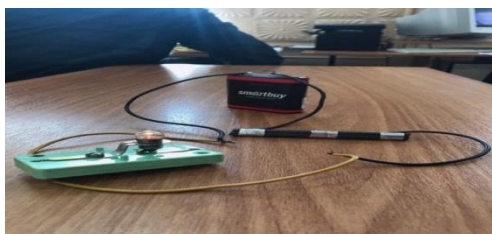
Рис. 1. Проводимость тока для стержней марки 2В
