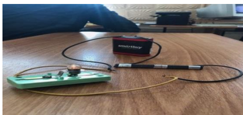
Рис. 1. Проводимость тока для стержней марки 2В
