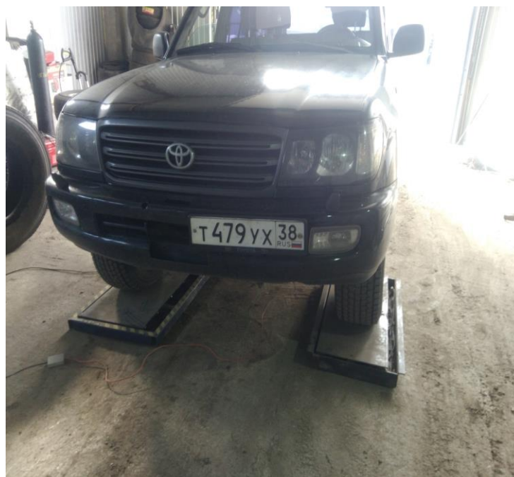
Рис. 6. Автомобиль на экспресс-стенде с двумя площадками
