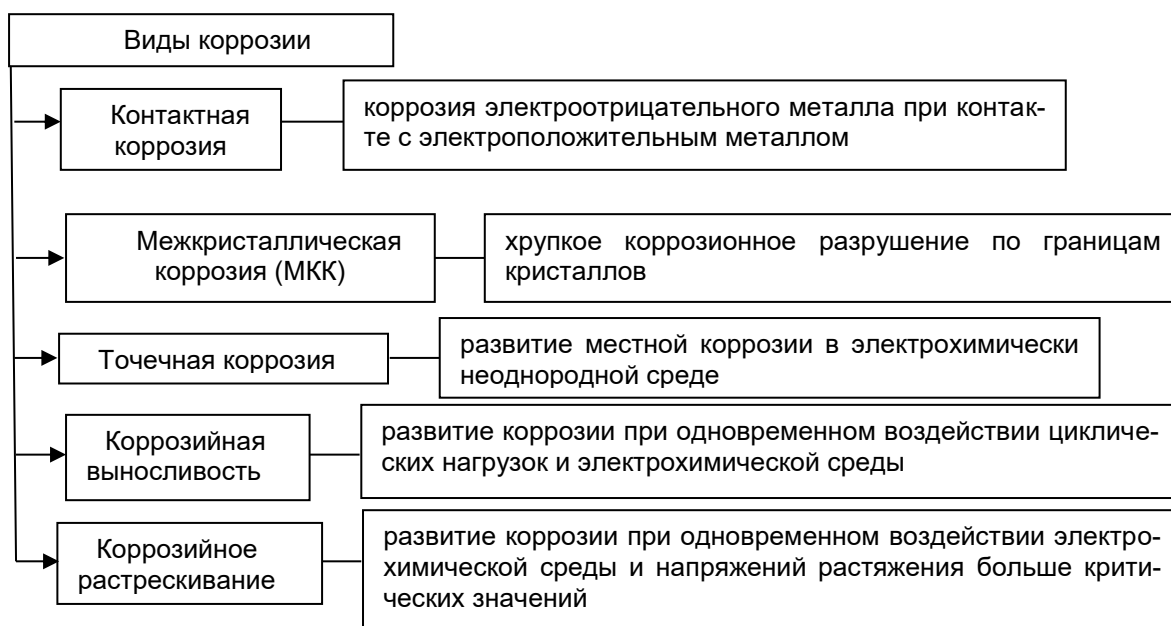
Рис. 1. Виды местного коррозионного разрушения
