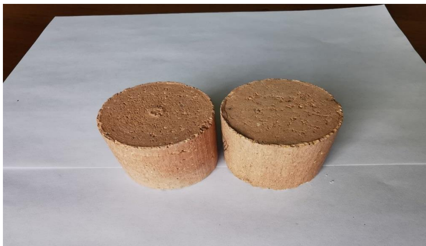
Рис. 1. Стандартные огнеупорные изделия, используемые при определении пористости, водопоглощения, объемной массы и термостойкости
