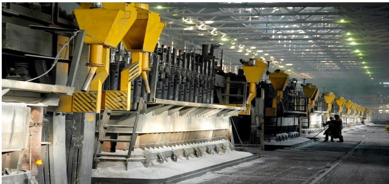
Рис. 1. Корпус электролиза с установленными ваннами типа С-8БМ
