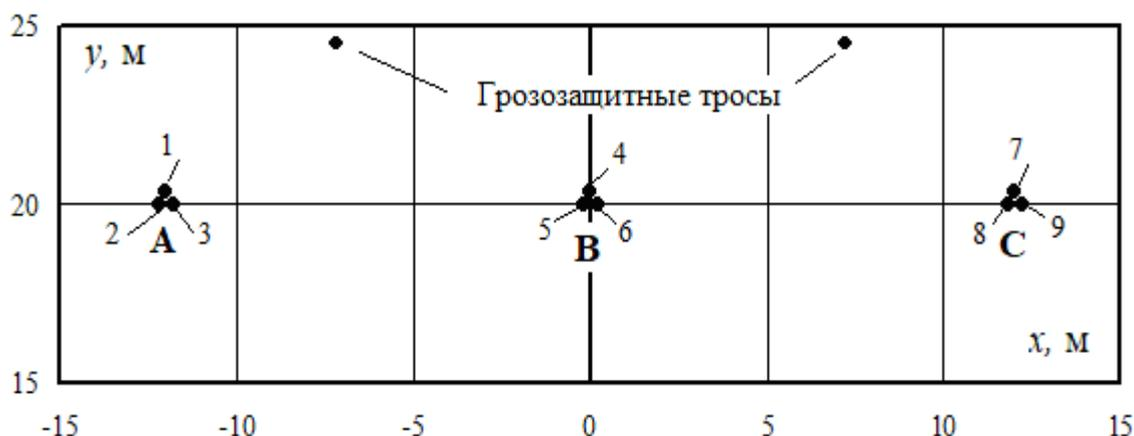
Рис. 1. Координаты проводов и грозозащитных тросов
