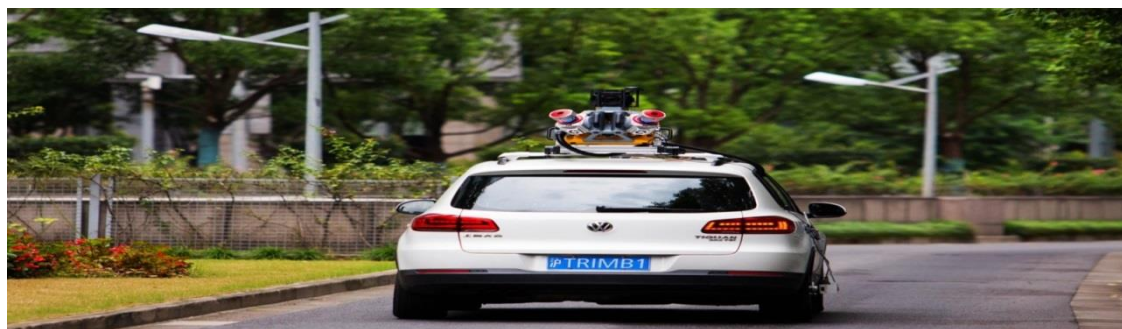
Рис. 3. Лазерный сканер устанавливается на крышу автомобиля
