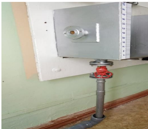
Рис. 4. Подключение резервуара к сливной системе
