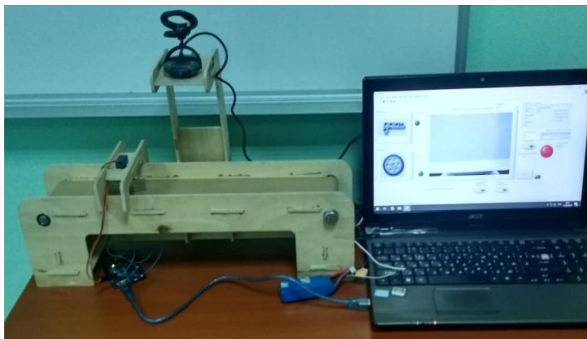
Рис. 1. Прототип системы технического зрения для контроля и сортировки
