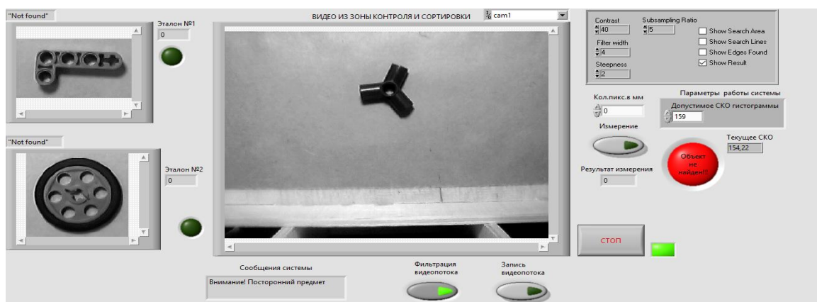
Рис. 11. Обнаружение постороннего предмета во время работы прототипа
