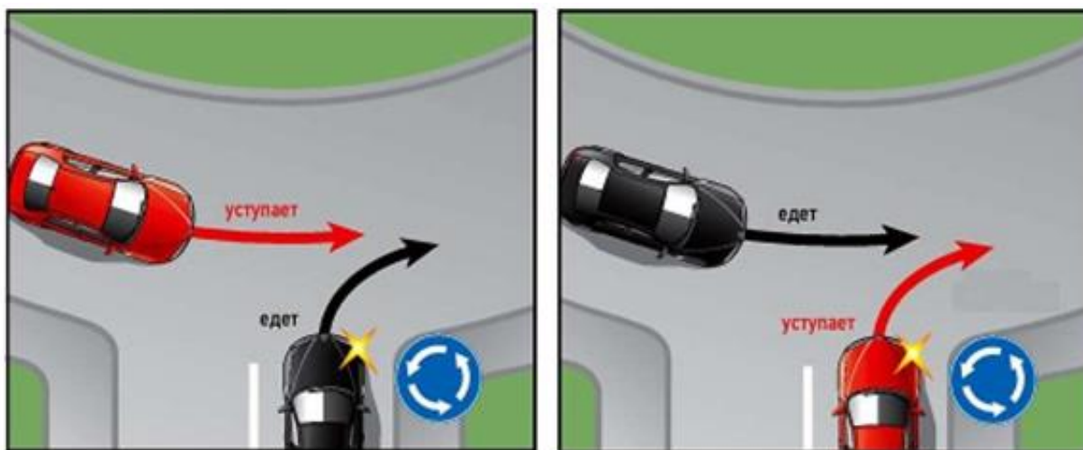
Рис. 4. Варианты организации движения на кольцевом пересечении: а – приоритетом в движении пользуется въезжающий поток, б – приоритетом в движении пользуется кольцевой поток
