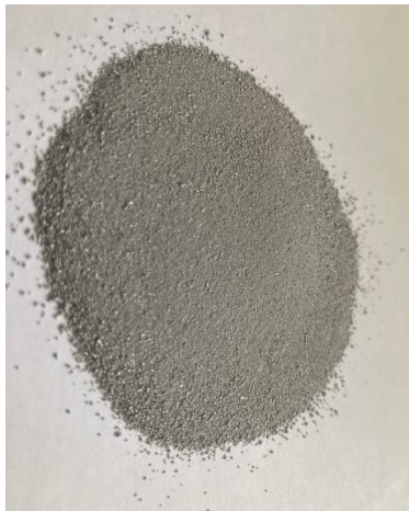
Рис. 5. Общий вид алюминиевого порошка (пудры) с средним размером частиц по гранулометрическому составу 17 мкм
