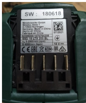
Рис. 1. Заводское клеймо-наклейка и контактная группа узла подключения источника питания к оборудованию
