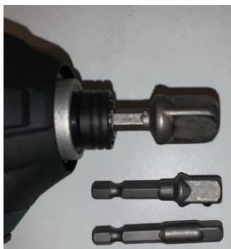
Рис. 5. Компоновка инструментальной наладки трех вариантов установки универсальных соединительных переходников с 1/4" HEX на 1/4", 3/8" и 1/2" квадрат под инструментальную головку
