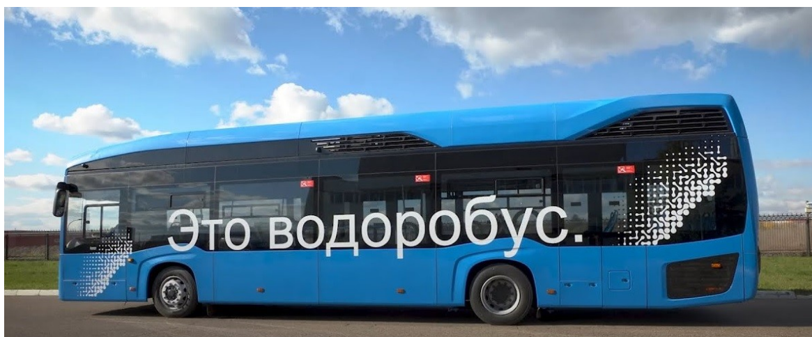
Рис. 3. Водоробус КамАЗ-6290 с водородной энергоустановкой мощностью 45 кВт
