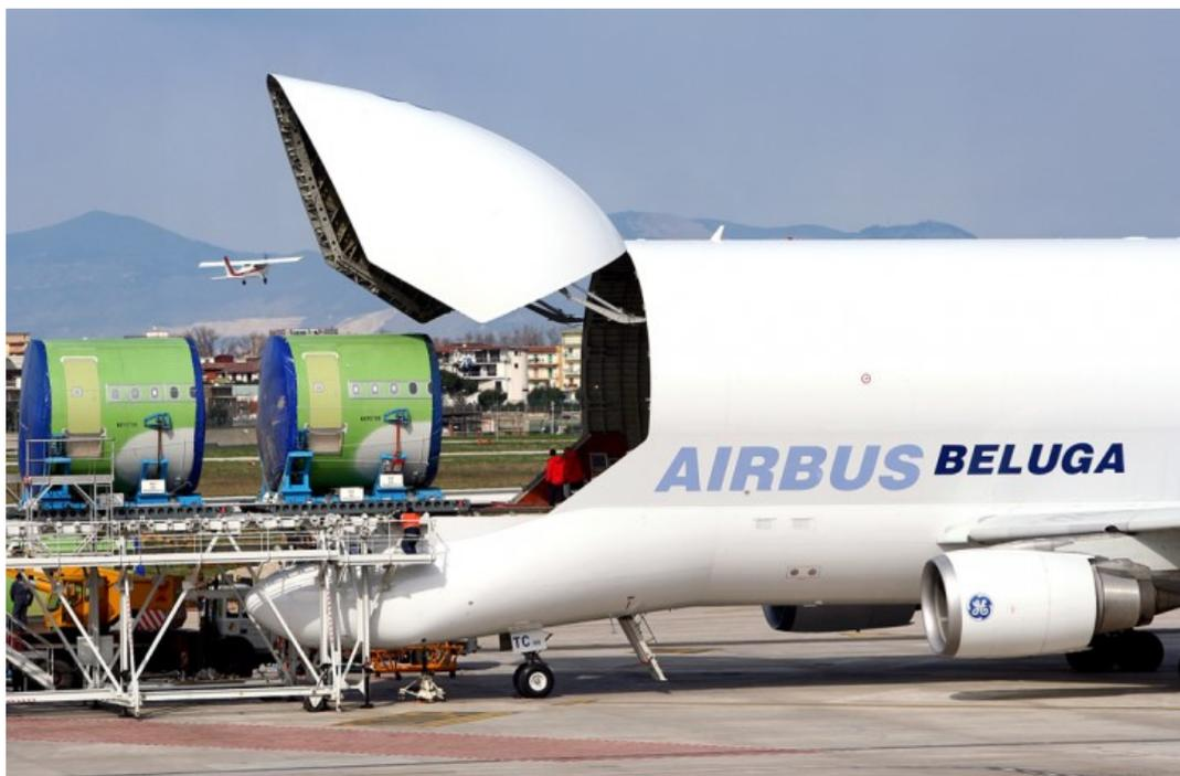
Рис. 8. Процесс отгрузки элементов фюзеляжа из Airbus Beluga
