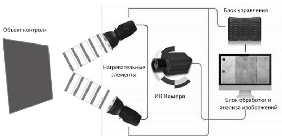
Рис. 1. Схема контроля методом «машинного зрения» активной термографии
