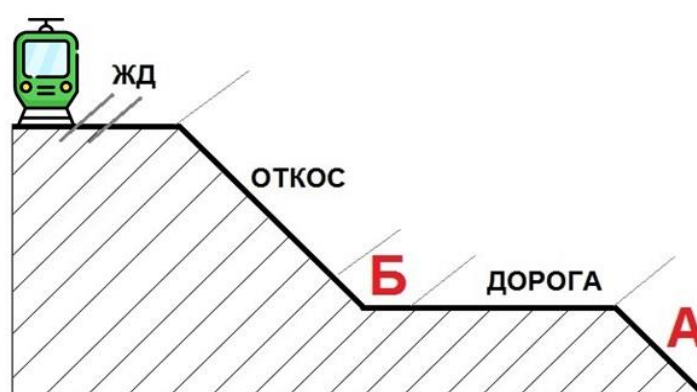
Рис. 2. Разрез Правобережной плотины БГЭС
