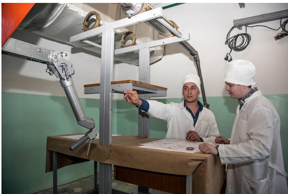
Рис. 10. Манипулятор МК-8 в герметичном исполнении, созданный на ПО «Маяк», для эксплуатации в условиях жесткого ионизирующего излучения, с использованием свинцового стекла
