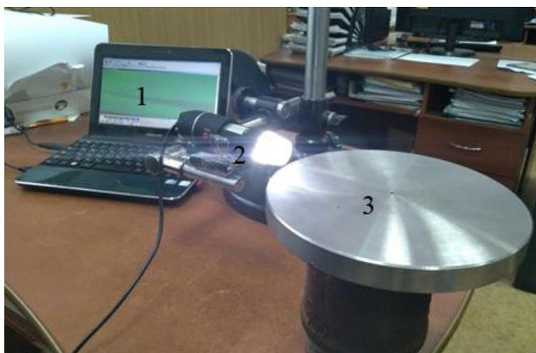
Рис. 1. Установка для изучения смазывающих свойств масел: 1 – компьютер, получающий изображение с микроскопа; 2 – цифровой микроскоп; 3 – исследуемая поверхность
