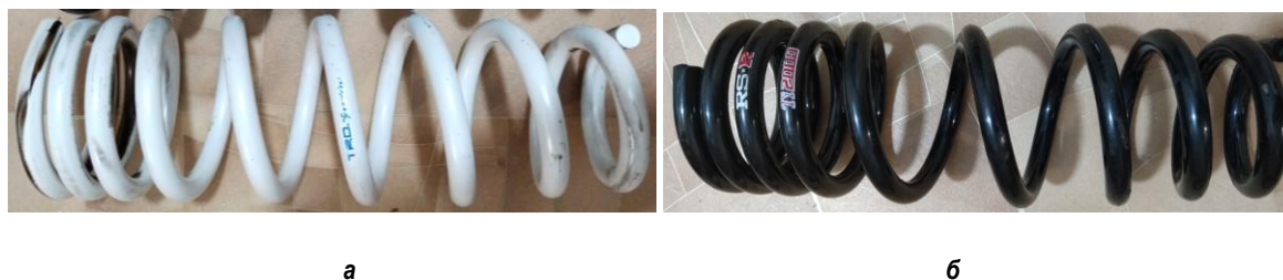
Рис. 3. Упругие элементы задней подвески (пружины) для Toyota Wish: а – RS★R TI2000, б – TRD sportivo
