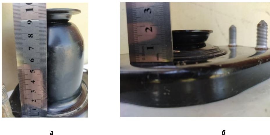
Рис. 2. Верхние опоры пружины: а – рассматриваемые модели, б – модель Wish
