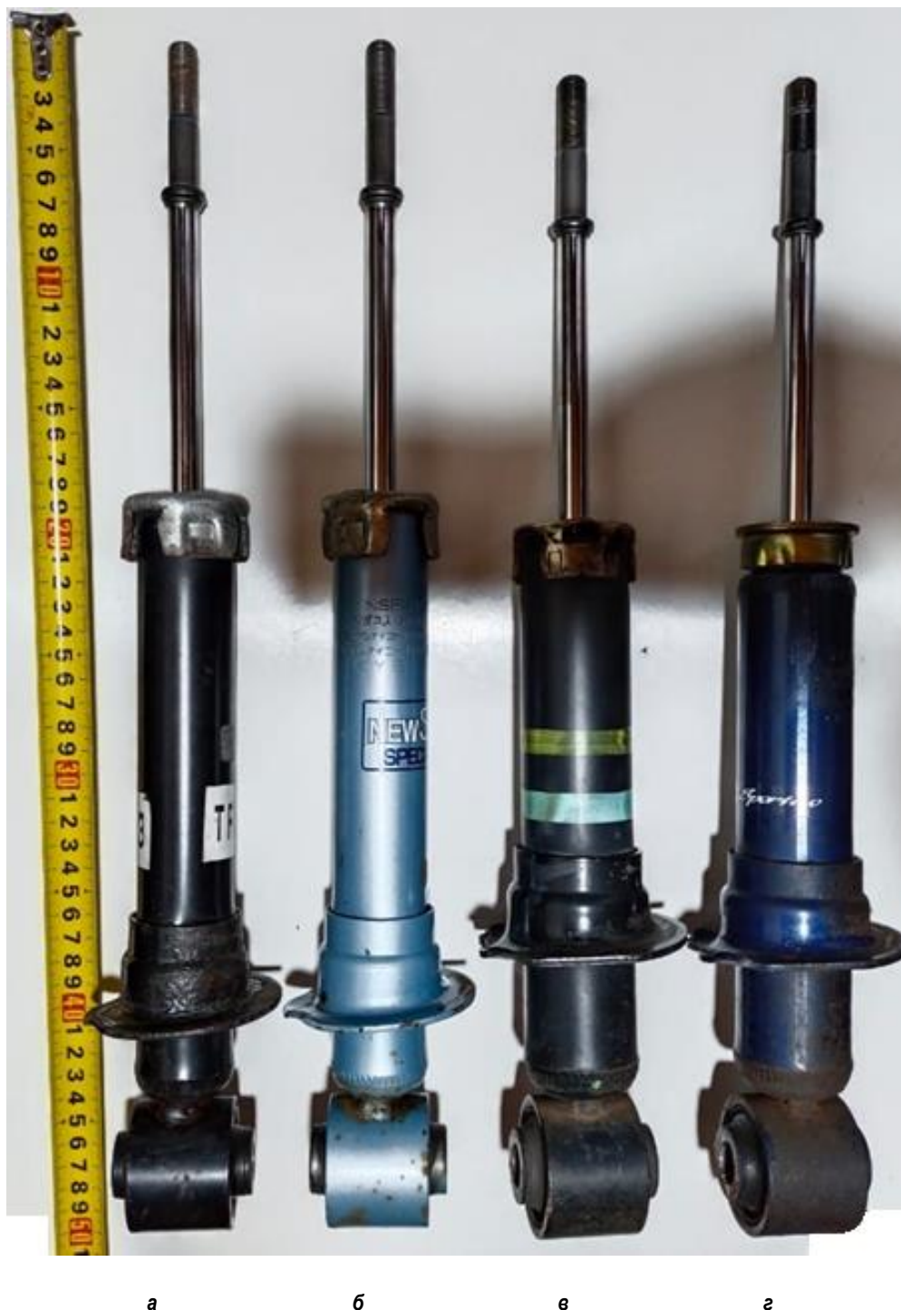
Рис. 5. Демпфирующие элементы (амортизаторы): а – штатный от Toyota Corolla Fielder, б – усиленный от Toyota Corolla Fielder, в – штатный от Toyota Wish, г – усиленный от Toyota Wish
