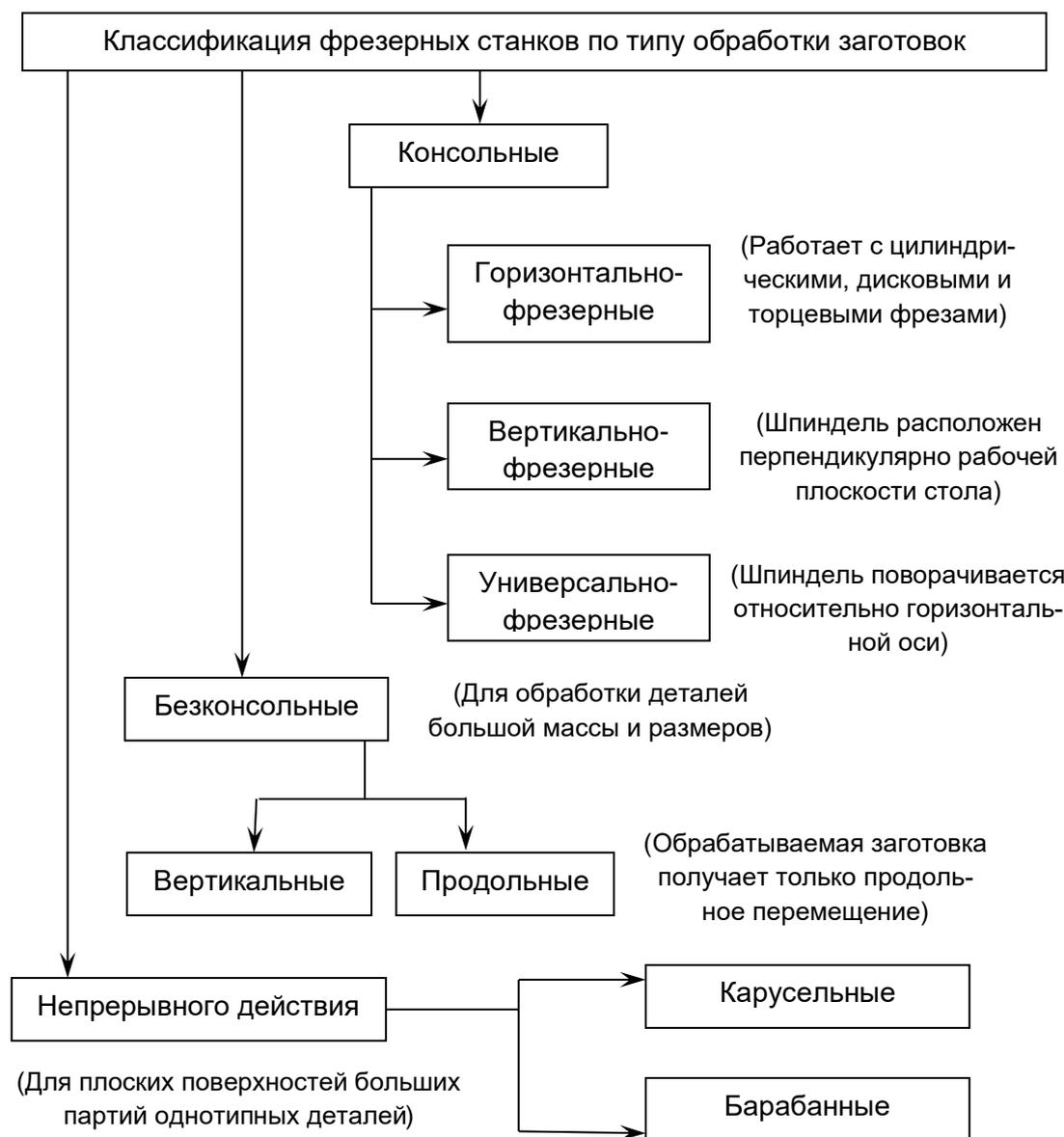
Рис. 1. Классификация фрезерных станков по типу обработки заготовок
