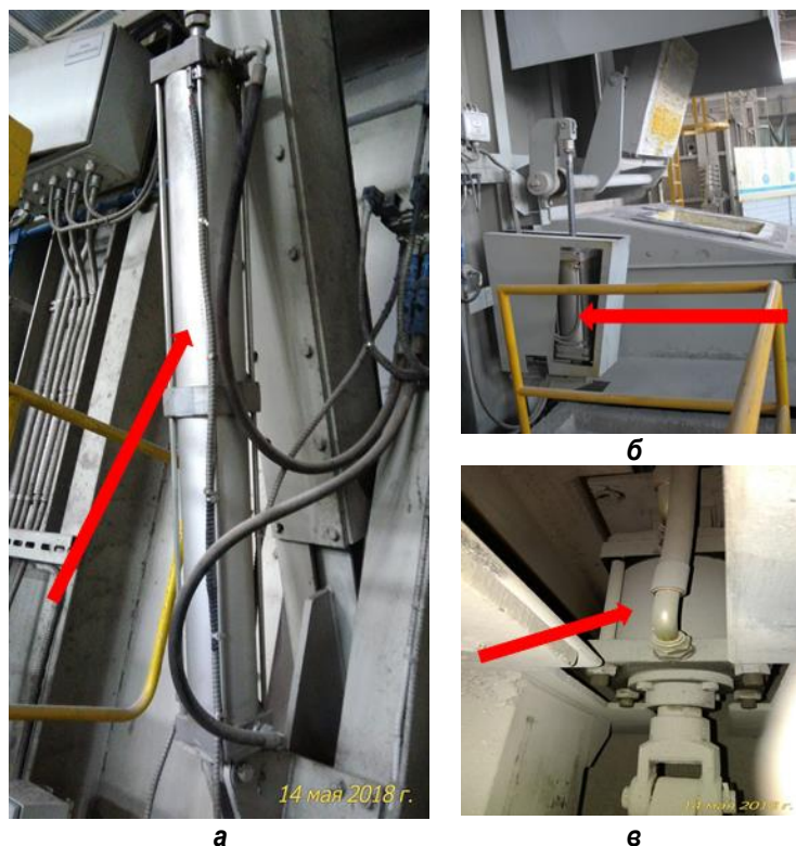
Рис. 5. Пневматические цилиндры: а – погружной термодатчик; б – крышки заливного кармана; в – прижима двери форкамеры
