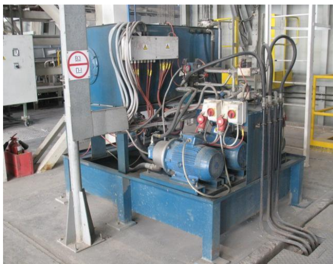
Рис. 4. Гидравлическая маслостанция миксера: а – общий вид; б – гидроцилиндры
