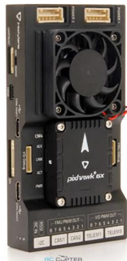
Рис. 7. Полетный контроллер Holybro Pixhawk 6X + RPi CM4 base + PM03D + Raspberry Pi 4 9
