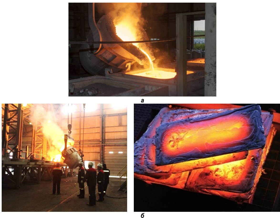
Рис. 4. Рафинированный кремний: а – разливка в изложницы (ТОО «Tau-Ken Temir»); б – разливка и слитки кремния из изложниц (АО «Кремний»)
