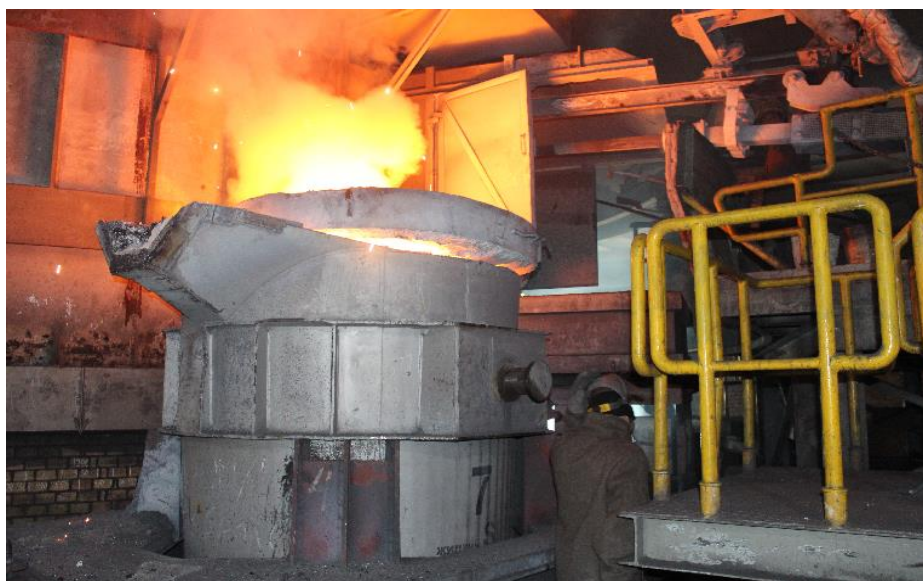
Рис. 3. Выпуск расплава кремния из печи в ковш (ТОО «Tau-Ken Temir»)
