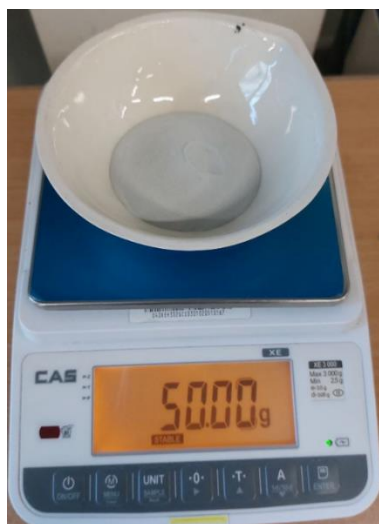
Рис. 4. Навеска пробы глинозема на весах CAS XE-3000
