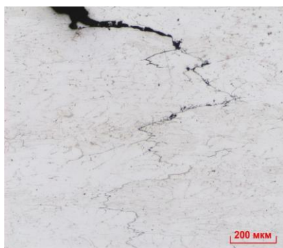
Рис. 7. Микроструктура горячекатаной ленты в долевом и поперечном сечении
