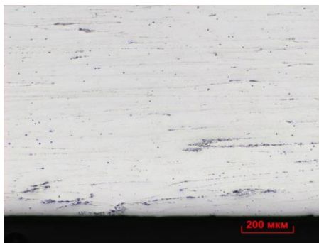
Рис. 7. Микроструктура горячекатаной ленты в долевом и поперечном сечении
